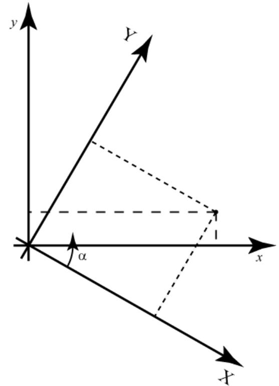
E' FACILE OSSERVARE CHE LA MATRICE DI ROTAZIONE DA OXY A Oxy E' LA TRASPOSTA DI QUELLA DA Oxy a OXY:
