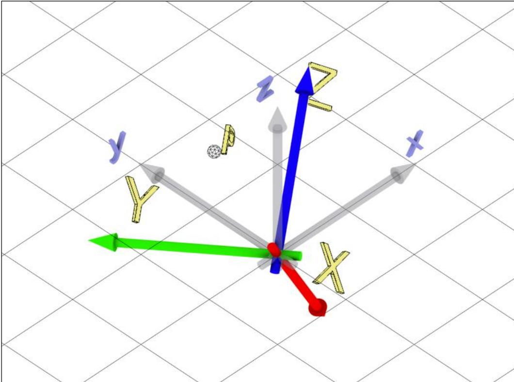
$$\begin{matrix} x \\ y \\ z \end{matrix} = R \cdot \begin{matrix} X \\ Y \\ Z \end{matrix} \quad R = R_{\kappa} \cdot R_{\phi} \cdot R_{\varpi}$$
